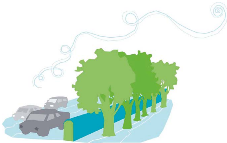
Låg, akustiskt absorberand skärm.
