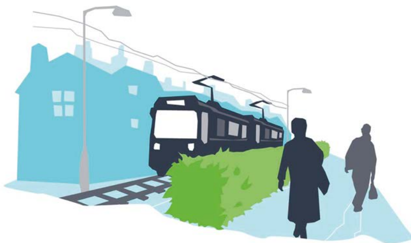
Låg, akustiskt absorberand skärm.
