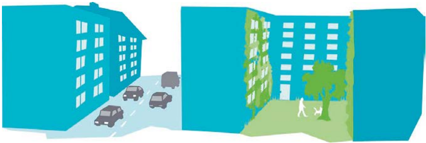
Bullerreducering med vegetation på husfasader vid innergård.
